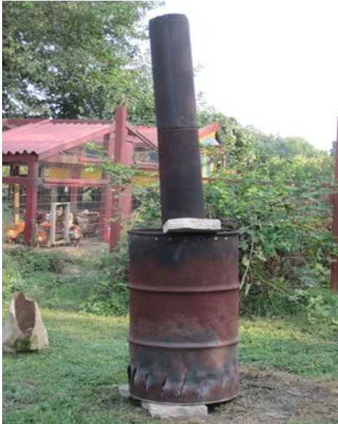
איור 3: מתקן להכנת ביוצ'אר, זהה לזה שבו השתמשנו
